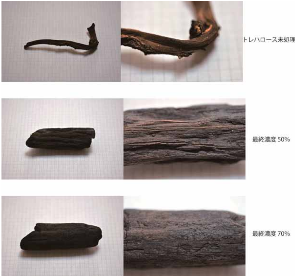
第6図 トレハロース処理濃度別遺物状況（脱色処理無）
